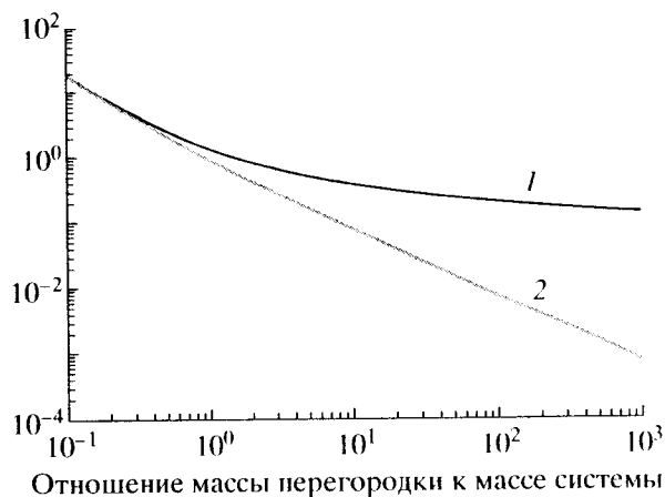
Рис. 2. Иллюстрация зависимости температуры (1) и энергии возбуждения (2) от отношения массы перегородки к массе системы.
